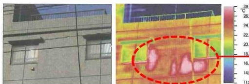
技術開発例： 赤外線サーモグラフィの解析 による断熱不良箇所の把握
